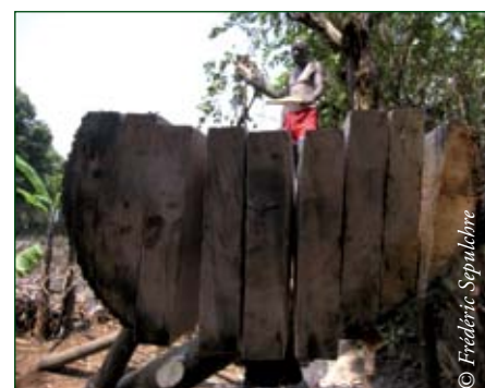
Photo 4.7 : Grume débitée par des scieurs de long
