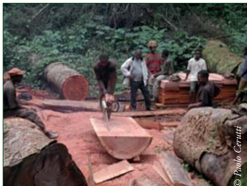
Photo 4.1 : Sciage en forêt au Cameroun, de la grume à la planche
